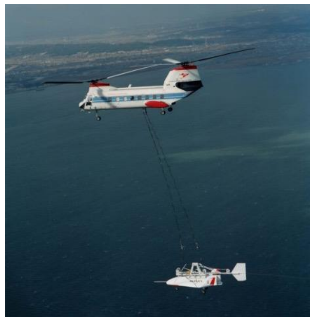
KV107II エアーリフト機による宇宙往還機(ALFLEX)吊り下げ飛行 1)
