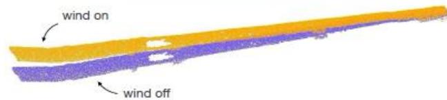
表面点群データからブレードの変形パラメータ (lead-lag, flap, torsion) の推定 & 3D形状再構成
